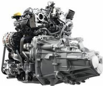
Le nouveau TCe 110 dispose d'une distribution variable, d'une pompe à huile à cylindrée variable et recourt à de nombreux matériaux plus efficaces pour favoriser les performances et réduire la consommation de carburant. Le collecteur d'échappement intégré, le filtre à particules et l'injecteur central contribuent à diminuer les émissions de CO<sub>2</sub>.
